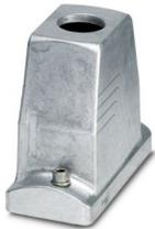
Carcaça HEAVYCON ADVANCE B16, com travamento a parafuso (hexagonal interno) de aço, alumínio resistente à água do mar, altura 100 mm, com rosca, saída de cabo reta 1x M32, sem superfície; vedação condutora (propriedades EMC)
