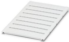
Marcador de terminais, Folha, branco, não impresso, identificável com: BLUEMARK ID COLOR, BLUEMARK ID, BLUEMARK CLED, PLOTMARK, CMS-P1-PLOTTER, tipo de montagem: travamento, para a largura de terminal: 6,2 mm, tamanho para gravação: 5,6 x 10,5 mm, Quantidade de plaquetas de identificação: 80
