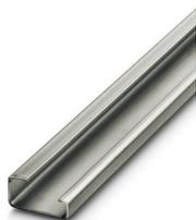
Trilho de fixação não perfurado, Variante de embalagem com 10 unidades (20 m), de acordo com EN 60715:, material: Aço, galvanizado, bicromatizado, Perfil G, cor: cores prat.
