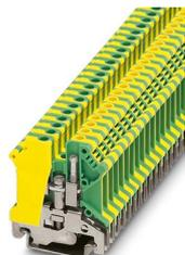
Borne terra, Na disposição em borne de passagem com a mesma forma, aplicar uma tampa > 690 V para as tensões de isolamento, quantidade de conexões: 2, tipo de conexão: Conexão a parafuso, perfil de conexão: 0,2 mm<sup>2</sup> - 6 mm<sup>2</sup>, tipo de fixação: Base PE com parafuso de fixação, M3, tipo de montagem: NS 35/7,5, NS 35/15, NS 32, cor: verde-amarelo
