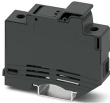
Borne de carril para fusible, tipo de fusible: Cerámica, tipo de fusible: 10,3 x 38 mm, tensión nominal: 690 V AC, corriente nominal: 32 A, número de polos: 1, tipo de conexión: Conexión por tornillo, Sección de dimensionamiento: 16 mm<sup>2</sup>, sección: 1 mm<sup>2</sup>- 16 mm<sup>2</sup>, clase de montaje: NS 35/7,5, NS 35/15, color: negro
