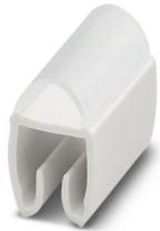
Soporte para señalización de conductores, transparente, sin rotular, rango de diámetro de cable: 2,8 ... 4,4 mm, clase de montaje: enganchar, altura del campo de texto: 4 mm, anchura del campo de texto: 10 mm
