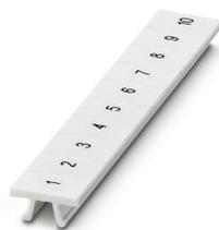
クイックマーカ-、ラベリング、白、マーキングあり、ラベリング可能: CMS-P1-PLOTTER、横方向に印字: 連番 ( 1 ... 10、11 ... 20など、491 ... 500まで )、取付けタイプ: スナップ式、端子台幅: 6.2 mm、印字エリア: 6.15 x 10.5 mm、個別ラベル数: 10
