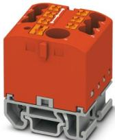
Blocco distributore, Blocco con orientamento orizzontale e alimentazione integrata, tensione nominale: 690 V, corrente nominale: 24 A, numero di connessioni: 7, tipo di connessione: Connessione Push-in, Sezione di dimensionamento: 2,5 mm<sup>2</sup>, Presa, sezione: 0,14 mm<sup>2</sup> - 4 mm<sup>2</sup>, Connessione Push-in, Connessione collettiva, Sezione di dimensionamento: 6 mm<sup>2</sup>, sezione: 0,5 mm<sup>2</sup> - 10 mm<sup>2</sup>, tipo di montaggio: NS 15, colore: rosso
