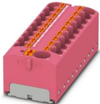
Blocco distributore, ponticellato internamente, tensione nominale: 450 V, corrente nominale: 41 A, numero di connessioni: 19, tipo di connessione: Connessione Push-in, Sezione di dimensionamento: 4 mm<sup>2</sup>, Presa, sezione: 0,2 mm<sup>2</sup> - 6 mm<sup>2</sup>, Connessione Push-in, Connessione collettiva, Sezione di dimensionamento: 10 mm<sup>2</sup>, sezione: 0,5 mm<sup>2</sup> - 10 mm<sup>2</sup>, tipo di montaggio: incollare, colore: fucsia
