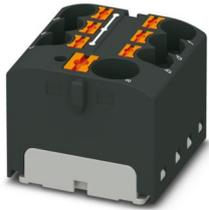
Blocco distributore, ponticellato internamente, tensione nominale: 450 V, corrente nominale: 32 A, numero di connessioni: 7, tipo di connessione: Connessione Push-in, Sezione di dimensionamento: 4 mm<sup>2</sup>, Presa, sezione: 0,2 mm<sup>2</sup> - 6 mm<sup>2</sup>, Connessione Push-in, Connessione collettiva, Sezione di dimensionamento: 10 mm<sup>2</sup>, sezione: 0,5 mm<sup>2</sup> - 10 mm<sup>2</sup>, tipo di montaggio: incollare, colore: nero
