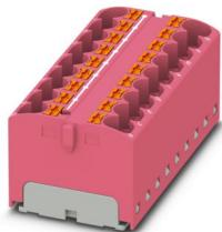
Blocco distributore, ponticellato internamente, tensione nominale: 450 V, corrente nominale: 32 A, numero di connessioni: 18, tipo di connessione: Connessione Push-in, sezione: 0,2 mm<sup>2</sup> - 6 mm<sup>2</sup>, tipo di montaggio: incollare, colore: fucsia
