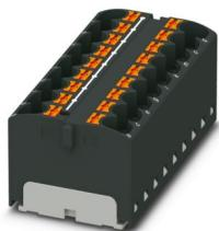
Blocco distributore, ponticellato internamente, tensione nominale: 450 V, corrente nominale: 32 A, numero di connessioni: 18, tipo di connessione: Connessione Push-in, sezione: 0,2 mm<sup>2</sup> - 6 mm<sup>2</sup>, tipo di montaggio: incollare, colore: nero
