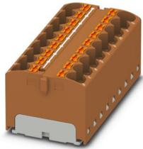
Blocco distributore, ponticellato internamente, tensione nominale: 450 V, corrente nominale: 32 A, numero di connessioni: 18, tipo di connessione: Connessione Push-in, sezione: 0,2 mm<sup>2</sup> - 6 mm<sup>2</sup>, tipo di montaggio: incollare, colore: marrone
