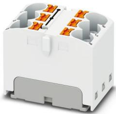
Blocco distributore, ponticellato internamente, tensione nominale: 450 V, corrente nominale: 32 A, numero di connessioni: 6, tipo di connessione: Connessione Push-in, sezione: 0,2 mm<sup>2</sup> - 6 mm<sup>2</sup>, tipo di montaggio: incollare, colore: bianco
