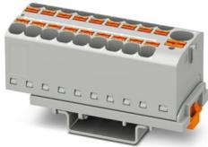
Blocco distributore, Blocco con orientamento verticale e alimentazione integrata, tensione nominale: 800 V, corrente nominale: 32 A, numero di connessioni: 19, tipo di connessione: Connessione Push-in, Sezione di dimensionamento: 4 mm<sup>2</sup>, Presa, sezione: 0,2 mm<sup>2</sup> - 6 mm<sup>2</sup>, Connessione Push-in, Connessione collettiva, Sezione di dimensionamento: 10 mm<sup>2</sup>, sezione: 0,5 mm<sup>2</sup> - 10 mm<sup>2</sup>, tipo di montaggio: NS 35/7,5, NS 35/15, colore: grigio
