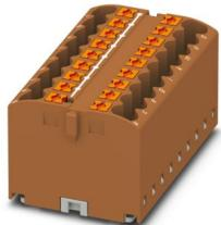
Blocco distributore, Morsetto base, tensione nominale: 450 V, corrente nominale: 24 A, numero di connessioni: 18, tipo di connessione: Connessione Push-in, sezione: 0,14 mm<sup>2</sup> - 4 mm<sup>2</sup>, tipo di montaggio: incollare, colore: marrone
