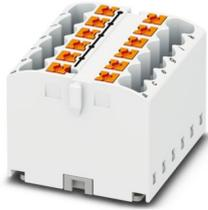
Blocco distributore, Morsetto base, tensione nominale: 450 V, corrente nominale: 24 A, numero di connessioni: 12, tipo di connessione: Connessione Push-in, sezione: 0,14 mm<sup>2</sup> - 4 mm<sup>2</sup>, tipo di montaggio: incollare, colore: bianco
