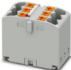
Blocco distributore, Morsetto base, tensione nominale: 450 V, corrente nominale: 24 A, numero di connessioni: 6, tipo di connessione: Connessione Push-in, sezione: 0,14 mm<sup>2</sup> - 4 mm<sup>2</sup>, tipo di montaggio: incollare, colore: grigio
