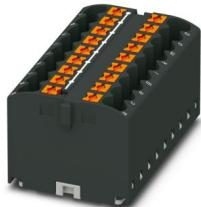
Blocco distributore, Morsetto base, tensione nominale: 450 V, corrente nominale: 24 A, numero di connessioni: 18, tipo di connessione: Connessione Push-in, sezione: 0,14 mm<sup>2</sup> - 4 mm<sup>2</sup>, tipo di montaggio: montaggio su adattatori per il fissaggio su guida di supporto, Montaggio diretto con flangia, Mobile, colore: nero
