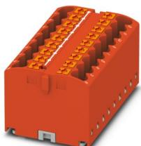
Blocco distributore, Morsetto base, tensione nominale: 450 V, corrente nominale: 24 A, numero di connessioni: 18, tipo di connessione: Connessione Push-in, sezione: 0,14 mm<sup>2</sup> - 4 mm<sup>2</sup>, tipo di montaggio: montaggio su adattatori per il fissaggio su guida di supporto, Montaggio diretto con flangia, Mobile, colore: rosso
