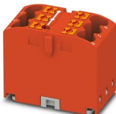
Blocco distributore, Morsetto base, tensione nominale: 450 V, corrente nominale: 24 A, numero di connessioni: 6, tipo di connessione: Connessione Push-in, sezione: 0,14 mm<sup>2</sup> - 4 mm<sup>2</sup>, tipo di montaggio: montaggio su adattatori per il fissaggio su guida di supporto, Montaggio diretto con flangia, Mobile, colore: rosso
