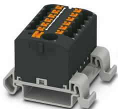
Blocco distributore, Blocco con orientamento orizzontale e alimentazione integrata, tensione nominale: 690 V, corrente nominale: 24 A, numero di connessioni: 13, tipo di connessione: Connessione Push-in, Sezione di dimensionamento: 2,5 mm<sup>2</sup>, Presa, sezione: 0,14 mm<sup>2</sup> - 4 mm<sup>2</sup>, Connessione Push-in, Connessione collettiva, Sezione di dimensionamento: 6 mm<sup>2</sup>, sezione: 0,5 mm<sup>2</sup> - 10 mm<sup>2</sup>, tipo di montaggio: NS 35/7,5, NS 35/15, colore: nero
