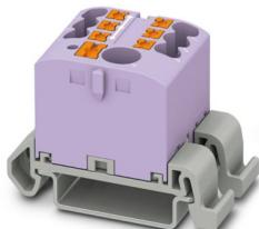
Blocco distributore, Blocco con orientamento orizzontale e alimentazione integrata, tensione nominale: 690 V, corrente nominale: 24 A, numero di connessioni: 7, tipo di connessione: Connessione Push-in, Sezione di dimensionamento: 2,5 mm<sup>2</sup>, Presa, sezione: 0,14 mm<sup>2</sup> - 4 mm<sup>2</sup>, Connessione Push-in, Connessione collettiva, Sezione di dimensionamento: 6 mm<sup>2</sup>, sezione: 0,5 mm<sup>2</sup> - 10 mm<sup>2</sup>, tipo di montaggio: NS 35/7,5, NS 35/15, colore: viola
