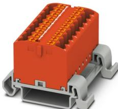
Blocco distributore, Blocco con orientamento orizzontale, tensione nominale: 690 V, corrente nominale: 24 A, numero di connessioni: 18, tipo di connessione: Connessione Push-in, sezione: 0,14 mm<sup>2</sup> - 4 mm<sup>2</sup>, tipo di montaggio: NS 35/7,5, NS 35/15, colore: rosso
