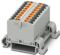
Blocco distributore, Blocco con orientamento orizzontale, tensione nominale: 690 V, corrente nominale: 24 A, numero di connessioni: 18, tipo di connessione: Connessione Push-in, sezione: 0,14 mm<sup>2</sup> - 4 mm<sup>2</sup>, tipo di montaggio: NS 35/7,5, NS 35/15, colore: grigio
