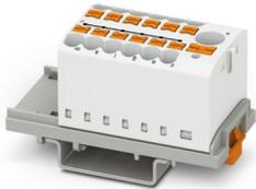
Blocco distributore, Blocco con orientamento verticale e alimentazione integrata, tensione nominale: 690 V, corrente nominale: 24 A, numero di connessioni: 13, tipo di connessione: Connessione Push-in, Sezione di dimensionamento: 2,5 mm<sup>2</sup>, Presa, sezione: 0,14 mm<sup>2</sup> - 4 mm<sup>2</sup>, Connessione Push-in, Connessione collettiva, Sezione di dimensionamento: 6 mm<sup>2</sup>, sezione: 0,5 mm<sup>2</sup> - 10 mm<sup>2</sup>, tipo di montaggio: NS 35/7,5, NS 35/15, colore: bianco
