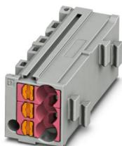
Blocco di ripartizione, tensione nominale: 500 V, corrente nominale: 17,5 A, tipo di connessione: Connessione Push-in, sezione: 0,14 mm<sup>2</sup> - 2,5 mm<sup>2</sup>, montaggio: montaggio su adattatori per il fissaggio su guida di supporto, montaggio su flangia di copertura, colore: grigio, elementi di connessione colore: fucsia
