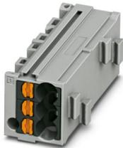
Blocco di ripartizione, tensione nominale: 500 V, corrente nominale: 17,5 A, tipo di connessione: Connessione Push-in, sezione: 0,14 mm<sup>2</sup> - 2,5 mm<sup>2</sup>, montaggio: montaggio su adattatori per il fissaggio su guida di supporto, montaggio su flangia di copertura, colore: grigio, elementi di connessione colore: nero
