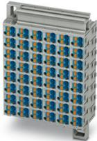
Blocco di ripartizione, Siglato da 1 - 48, tensione nominale: 500 V, corrente nominale: 17,5 A, tipo di connessione: Connessione Push-in, sezione: 0,14 mm<sup>2</sup> - 2,5 mm<sup>2</sup>, montaggio: Montaggio a parete, colore: grigio, elementi di connessione colore: blu
