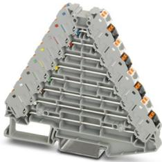
Ripartitore modulare, lato sinistro secondo VDE 0815, lato destro con patchbay bianchi e neri, tensione nominale: 250 V, corrente nominale: 8 A, tipo di connessione: Connessione Push-in, 1., 2., 3., 4., 5., 6., 7. e 8. piano, Sezione di dimensionamento: 1,5 mm<sup>2</sup>, sezione: 0,14 mm<sup>2</sup> - 2,5 mm<sup>2</sup>, montaggio: NS 35/7,5, NS 35/15, colore: grigio
