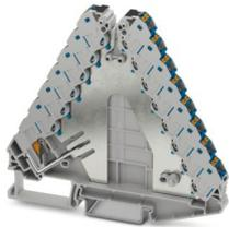
Ripartitore di potenziale, Con possibilità di alimentazione fino a  $6 \text{ mm}^2$ , tensione nominale: 250 V, corrente nominale: 17,5 A, tipo di connessione: Connessione Push-in, Sezione di dimensionamento:  $1,5 \text{ mm}^2$ , sezione:  $0,14 \text{ mm}^2 - 2,5 \text{ mm}^2$ , Piano di alimentazione, Sezione di dimensionamento:  $4 \text{ mm}^2$ , sezione:  $0,2 \text{ mm}^2 - 6 \text{ mm}^2$ , montaggio: NS 35/7,5, NS 35/15, colore: grigio, elementi di connessione colore: blu
