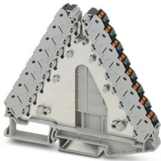
Ripartitore di potenziale, tensione nominale: 250 V, corrente nominale: 17,5 A, tipo di connessione: Connessione Push-in, 1., 2., 3., 4., 5., 6., 7. e 8. piano, Sezione di dimensionamento: 1,5 mm<sup>2</sup>, sezione: 0,14 mm<sup>2</sup> - 2,5 mm<sup>2</sup>, montaggio: NS 35/7,5, NS 35/15, colore: grigio, elementi di connessione colore: nero
