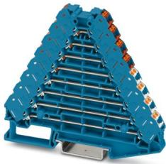
Ripartitore modulare, tensione nominale: 250 V, corrente nominale: 8 A, tipo di connessione: Connessione Push-in, 1., 2., 3., 4., 5., 6., 7. e 8. piano, Sezione di dimensionamento: 1,5 mm<sup>2</sup>, sezione: 0,14 mm<sup>2</sup> - 2,5 mm<sup>2</sup>, montaggio: NS 35/7,5, NS 35/15, colore: blu, elementi di connessione colore: rosso, bianco
