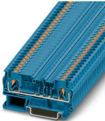
Morsetto passante, tensione nominale: 400 V, corrente nominale: 24 A, numero di connessioni: 2, tipo di connessione: Connessione Push-in, Sezione di dimensionamento: 2,5 mm<sup>2</sup>, 1. piano, sezione: 0,14 mm<sup>2</sup> - 4 mm<sup>2</sup>, tipo di montaggio: NS 35/7,5, NS 35/15, colore: blu
