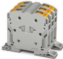
Morsetti di potenza, bloccato, tensione nominale: 1000 V, corrente nominale: 232 A, numero di connessioni: 6, numero poli: 3, tipo di connessione: Connessione PowerTurn, sezione: 25 mm<sup>2</sup> - 95 mm<sup>2</sup>, tipo di montaggio: avvitamento diretto, colore: grigio
