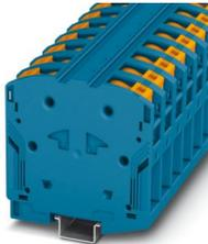
Morsetti di potenza, tensione nominale: 1000 V, corrente nominale: 232 A, numero di connessioni: 2, numero poli: 1, tipo di connessione: Connessione PowerTurn, sezione: 25 mm<sup>2</sup> - 95 mm<sup>2</sup>, tipo di montaggio: NS 35/15, colore: blu
