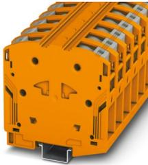
Morsetti di potenza, tensione nominale: 1000 V, corrente nominale: 150 A, numero di connessioni: 2, numero poli: 1, tipo di connessione: Connessione PowerTurn, 1. piano, sezione: 10 mm<sup>2</sup> - 70 mm<sup>2</sup>, tipo di montaggio: NS 35/15, colore: arancione
