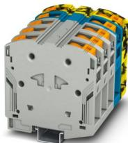
Morsetti di potenza, bloccato, tensione nominale: 1000 V, corrente nominale: 150 A, numero di connessioni: 10, numero poli: 5, tipo di connessione: Connessione PowerTurn, 1. piano, sezione: 10 mm<sup>2</sup> - 70 mm<sup>2</sup>, tipo di montaggio: NS 35/15, colore: grigio/blu/nero-giallo
