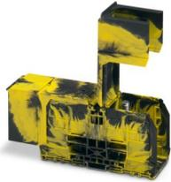
Morsetto di collegamento a bullone, tensione nominale: 1500 V, corrente nominale: 415 A, numero di connessioni: 2, numero poli: 1, tipo di connessione: Bullone, Sezione di dimensionamento: 240 mm<sup>2</sup>, tipo di montaggio: NS 35/7,5, NS 35/15, avvitamento diretto, colore: nero/giallo
