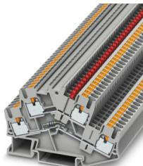
Componente morsetto componibile, tensione nominale: 24 V, corrente nominale: 22 A, tipo di connessione: Connessione Push-in, 1. piano, Sezione di dimensionamento: 2,5 mm<sup>2</sup>, sezione: 0,14 mm<sup>2</sup> - 4 mm<sup>2</sup>, tipo di montaggio: NS 35/7,5, NS 35/15, colore: grigio
