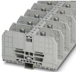
Morsetto di collegamento a bullone, tensione nominale: 1000 V, corrente nominale: 520 A, numero di connessioni: 2, numero poli: 1, tipo di connessione: Bullone, Sezione di dimensionamento: 300 mm<sup>2</sup>, tipo di montaggio: NS 35/7,5, NS 35/15, colore: grigio
