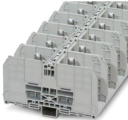
Morsetto di collegamento a bullone, tensione nominale: 1000 V, corrente nominale: 415 A, numero di connessioni: 2, numero poli: 1, tipo di connessione: Bullone, Sezione di dimensionamento: 240 mm<sup>2</sup>, tipo di montaggio: NS 35/7,5, NS 35/15, Montaggio flangia, colore: grigio
