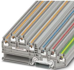
Morsetto iniziatore/attuatore, con funzione di terra, tensione nominale: 250 V, corrente nominale: 13,5 A, numero di connessioni: 7, tipo di connessione: Connessione Push-in, Sezione di dimensionamento: 1,5 mm<sup>2</sup>, sezione: 0,14 mm<sup>2</sup> - 1,5 mm<sup>2</sup>, tipo di montaggio: NS 35/7,5, NS 35/15, colore: grigio
