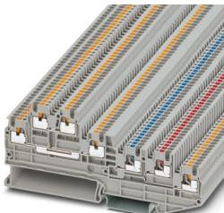
Morsetto iniziatore/attuatore, tensione nominale: 250 V, corrente nominale: 13,5 A, numero di connessioni: 7, tipo di connessione: Connessione Push-in, Sezione di dimensionamento: 1,5 mm<sup>2</sup>, sezione: 0,14 mm<sup>2</sup> - 1,5 mm<sup>2</sup>, tipo di montaggio: NS 35/7,5, NS 35/15, colore: grigio
