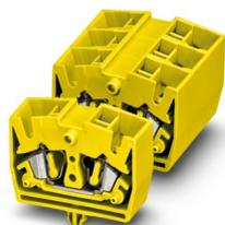
Minimorsetto passante, tensione nominale: 800 V, corrente nominale: 24 A, numero di connessioni: 4, tipo di connessione: Connessione a molla, Sezione di dimensionamento: 2,5 mm<sup>2</sup>, 1. piano, sezione: 0,08 mm<sup>2</sup> - 4 mm<sup>2</sup>, tipo di montaggio: Su piastra di montaggio, colore: giallo
