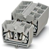
Minimorsetto passante, tensione nominale: 800 V, corrente nominale: 24 A, numero di connessioni: 4, tipo di connessione: Connessione a molla, Sezione di dimensionamento: 2,5 mm<sup>2</sup>, 1. piano, sezione: 0,08 mm<sup>2</sup> - 4 mm<sup>2</sup>, tipo di montaggio: Su piastra di montaggio, colore: grigio
