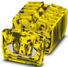
Minimorsetto passante, Montaggio con flangia o perno di arresto, tensione nominale: 800 V, corrente nominale: 24 A, numero di connessioni: 2, tipo di connessione: Connessione a molla, Sezione di dimensionamento: 2,5 mm<sup>2</sup>, 1. piano, sezione: 0,08 mm<sup>2</sup> - 4 mm<sup>2</sup>, tipo di montaggio: altro, colore: nero/giallo
