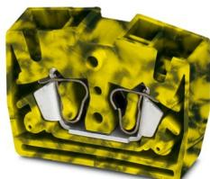
Minimorsetto passante, tensione nominale: 800 V, corrente nominale: 24 A, numero di connessioni: 4, tipo di connessione: Connessione a molla, Sezione di dimensionamento: 2,5 mm<sup>2</sup>, 1. piano, sezione: 0,08 mm<sup>2</sup> - 4 mm<sup>2</sup>, tipo di montaggio: Montaggio diretto con flangia, colore: nero/giallo
