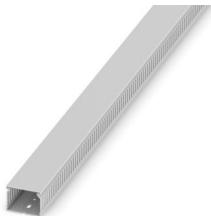
Canale di cablaggio per l'installazione e il montaggio in quadri elettrici, grigio, composto da parte superiore e parte inferiore, larghezza: 60 mm, altezza: 40 mm, lunghezza 2000 mm
