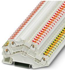
Morsetto passante a due piani, per bus KNX nell'installazione in edifici, confezionamento in coppie (25 coppie = 50 pezzi), tensione nominale: 500 V, corrente nominale: 16 A, tipo di connessione: Connessione Push-in, 1. e 2. piano, Sezione di dimensionamento: 1,5 mm<sup>2</sup>, sezione: 0,14 mm<sup>2</sup> - 1,5 mm<sup>2</sup>, tipo di montaggio: NS 35/7,5, NS 35/15, colore: bianco
