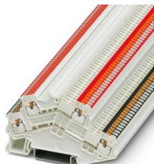
Morsetto passante a due piani, per bus KNX nell'installazione in edifici, tensione nominale: 500 V, corrente nominale: 16 A, tipo di connessione: Connessione Push-in, 1. e 2. piano, Sezione di dimensionamento: 1,5 mm<sup>2</sup>, sezione: 0,14 mm<sup>2</sup> - 1,5 mm<sup>2</sup>, tipo di montaggio: NS 35/7,5, NS 35/15, colore: bianco
