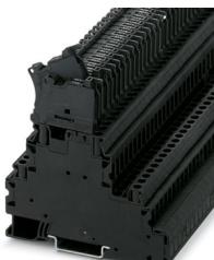
Morsetto portafusibili, tipo di fusibile: Vetro / ceramica / ..., tipo fusibile: G / 5 x 20, tensione nominale: 60 V, Corrente continua termica  $I_{th}$ : 28 A, tipo di connessione: Connessione a vite, Sezione di dimensionamento: 4 mm<sup>2</sup>, sezione: 0,14 mm<sup>2</sup>- 6 mm<sup>2</sup>, tipo di connessione: Connessione a vite, Sezione di dimensionamento: 4 mm<sup>2</sup>, sezione: 0,14 mm<sup>2</sup>- 6 mm<sup>2</sup>, tipo di montaggio: NS 35/7,5, NS 35/15, colore: nero
